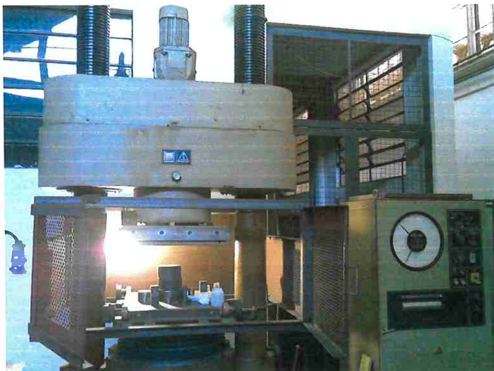
Figura 25 – Prensa utilizada para compactar as amostras com 700 MPa
