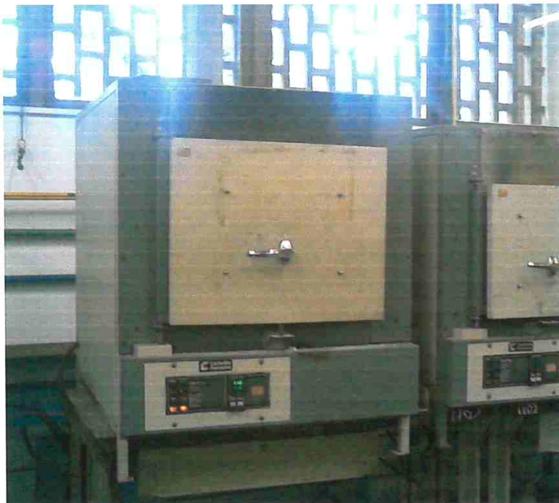
Figura 21 – Forno utilizado para aquecer as amostras de pó e a matriz
