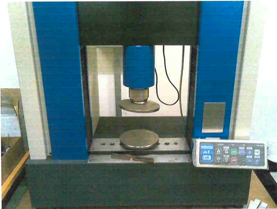
Figura 23 – Prensa utilizada para pré-compactação
