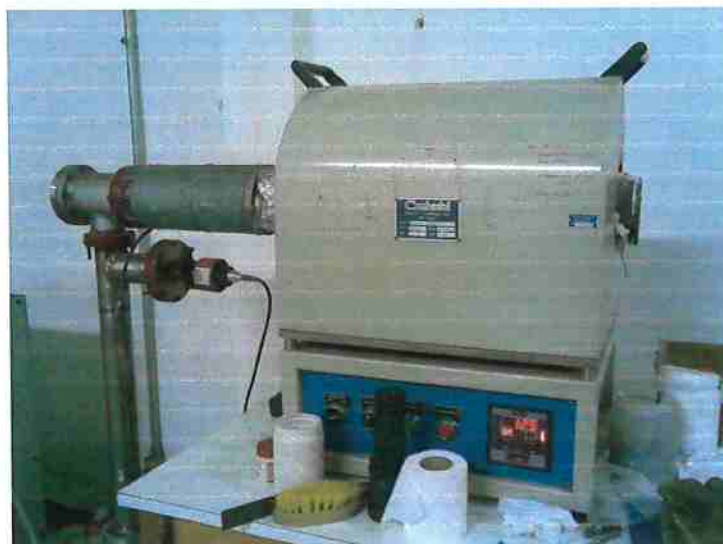
Figura 24 – Forno utilizado para aquecer o pó e a matriz
